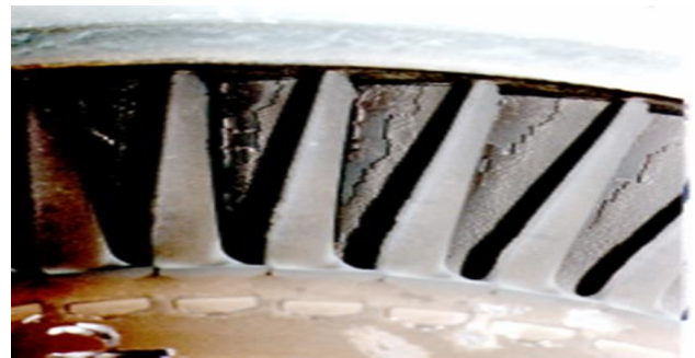
Hình 3. Ống phun bị bám bẩn bởi muối carbon tàu Long Maritime Evity.
