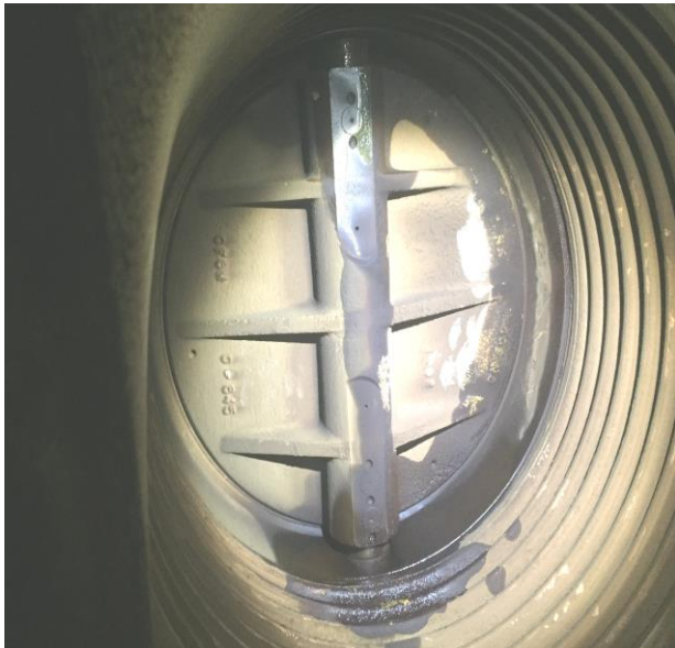
Hình 6. Van chặn trên đường khí xả vào tua bin tăng áp MET66MA.
