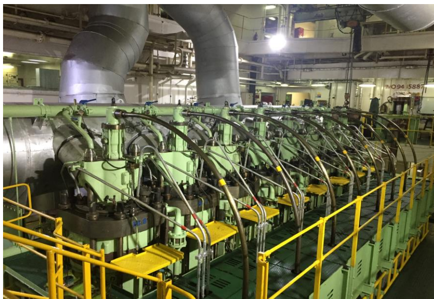
Hình 1. Động cơ Wärtsilä 8RT-flex68-D, 2 kỳ, 8 xi lanh, công suất 21.910 KW, 95 vòng/phút.
