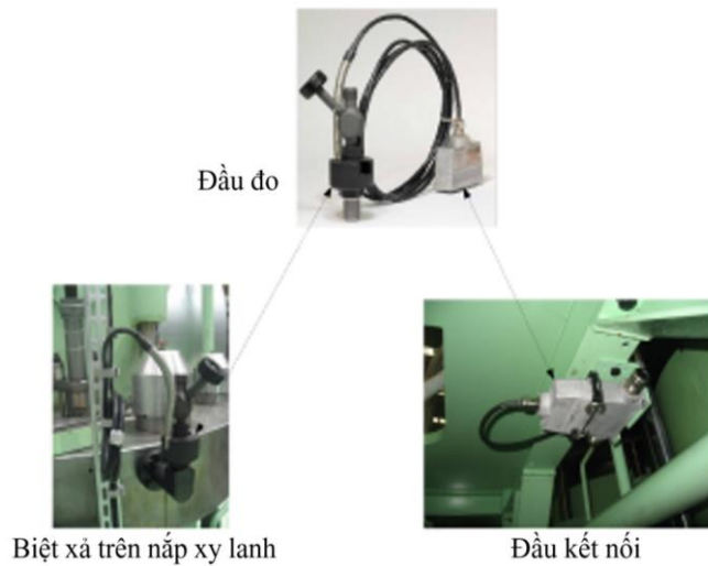
Hình 4. Cảm biến áp suất lắp cố định trên nắp xi lanh.
