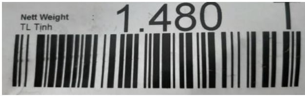
Hình 2. ID cuộn coil được xác định bằng mã vạch trên cuộn coil.
