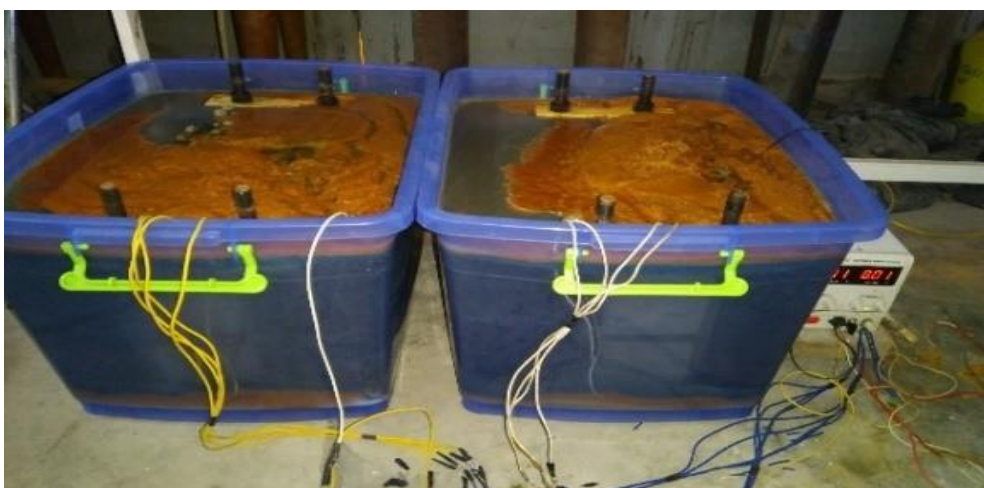
Hình 5. Quá trình ngâm thực nghiệm ăn mòn mẫu.
