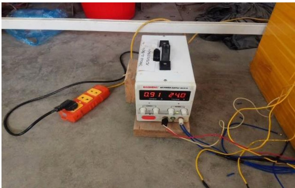
Hình 4. Dụng cụ tạo điều kiện ăn mòn điện.
