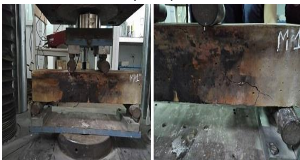
Hình 6. Tiến hành uốn 04 điểm đối với mẫu sau khi ngâm 30 ngày.
