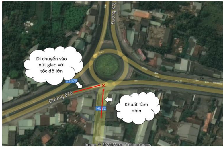
Hình 11. Mô tả sự nguy hiểm khi di chuyển từ đường HL32 ra nút giao vòng xoay.
