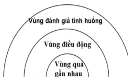
Hình 2. Các vùng áp dụng hành động tránh va khi có sự lại gần nhau tới mức nguy hiểm giữa hai tàu [6].
